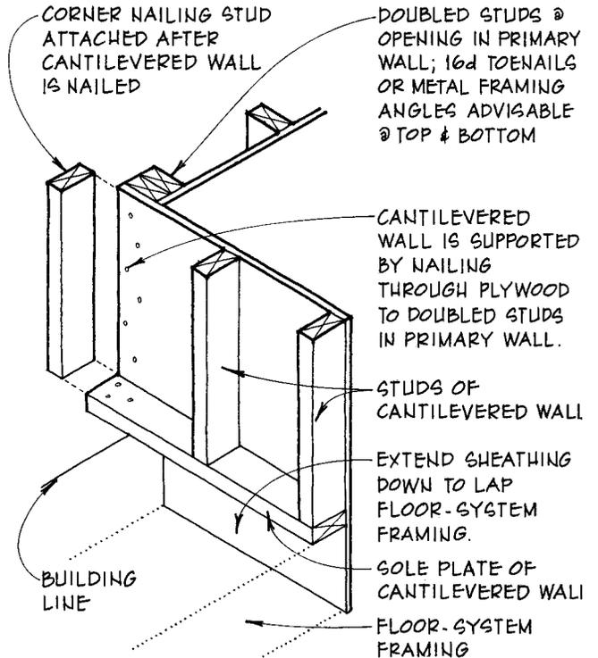
**D** CANTILEVERED-WALL FRAMING
