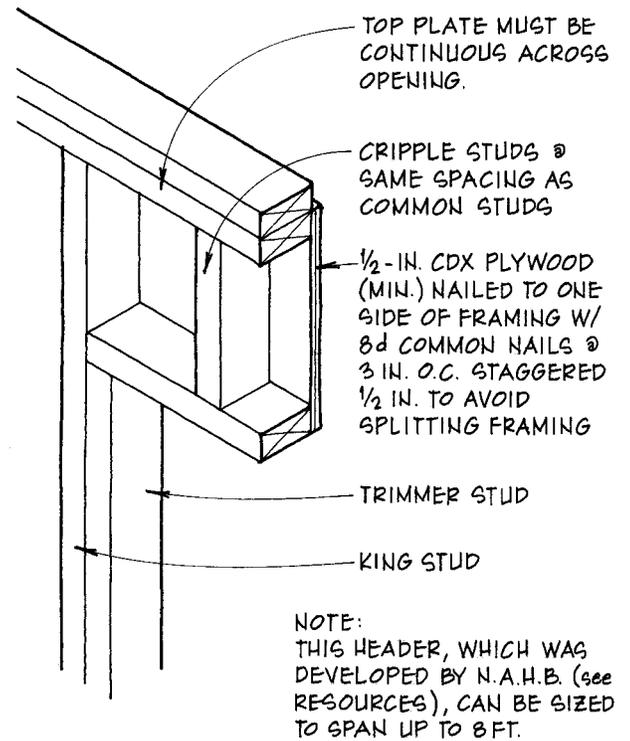
**D** OPEN-BOX PLYWOOD HEADER
